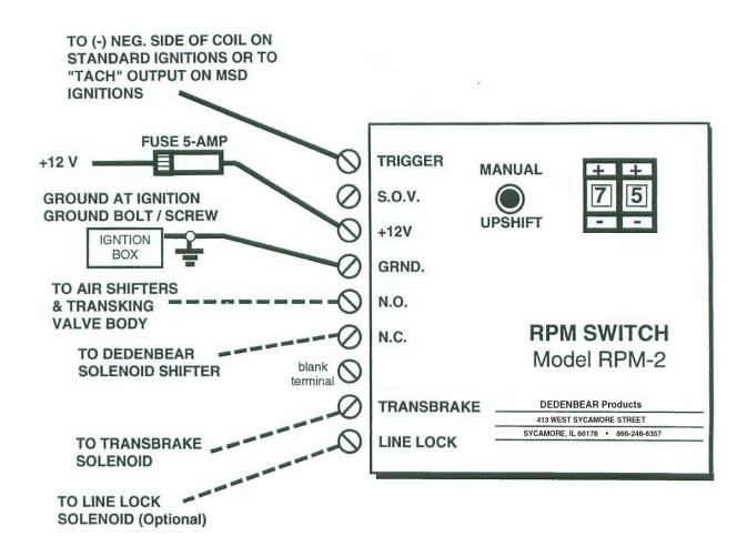
NOTE: IT IS IMPORTANT TO RUN THE "GROUND" WIRE FOR THE RPM SWJTCH ALL THE WAY TO THE IGNITION GROUND SCREW/BOLT. THIS IS SO THE RPM BOX CAN REFERENCE "COMMON GROUND" WITH THE IGNITION SYSTEM.
